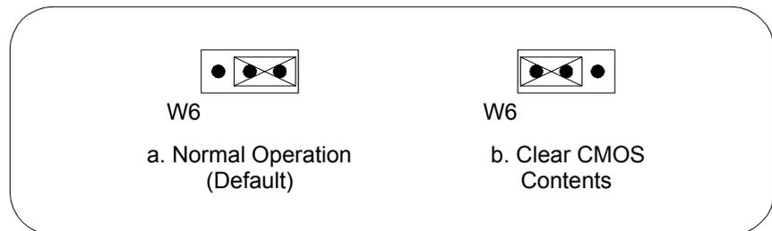
**Figure 5-6. System CMOS**
