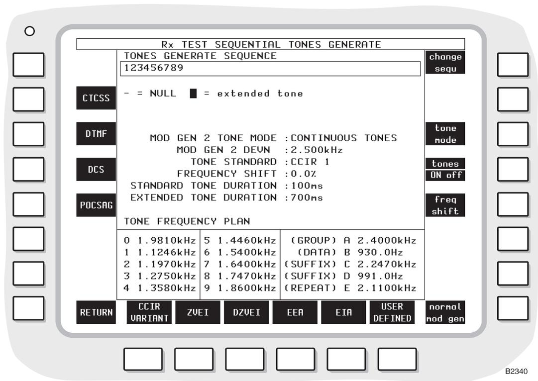
Fig. 3-29 Rx TEST SEQUENTIAL TONES GENERATE display
