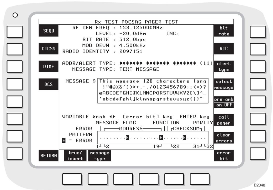
Fig. 3-38 Rx TEST POCSAG PAGER TEST display
