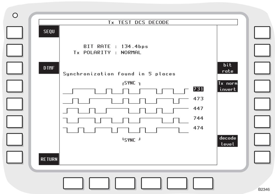
Fig. 3-36 Tx TEST DCS DECODE display
