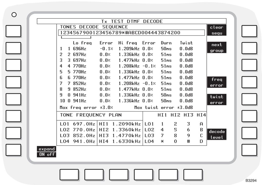
Fig. 3-33 Tx TEST DTMF DECODE display
