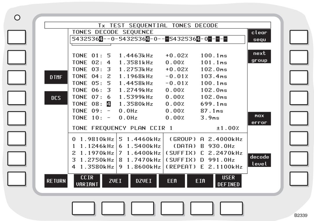
Fig. 3-28 Tx TEST SEQUENTIAL TONES DECODE display
