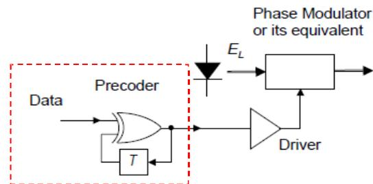
Figure 5.5-1 Pre-Code Logic (DQPSK) Diagram
